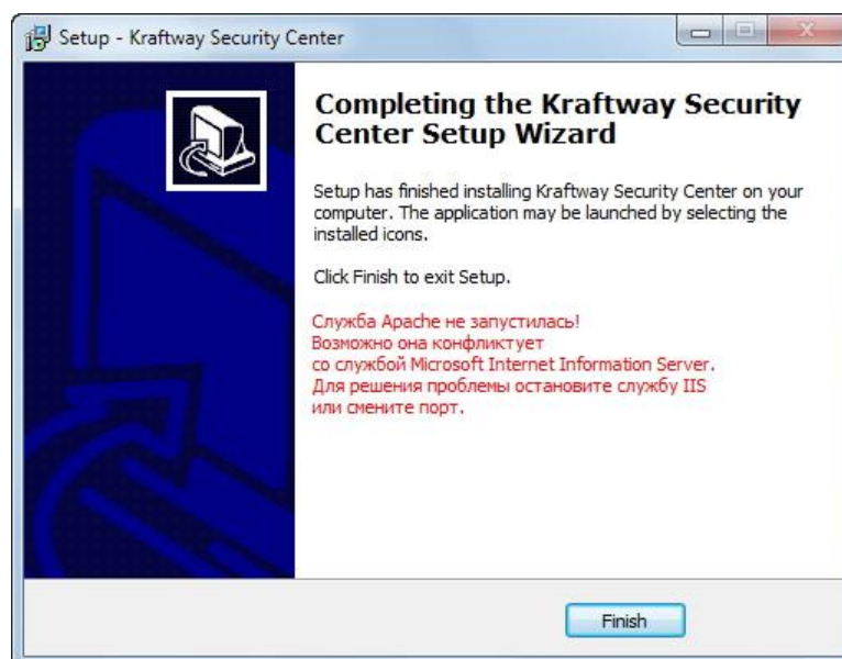
Рисунок 6.1 - Окно мастера установки Setup - Kraftway Security Center , работа мастера установки завершилась с ошибкой
