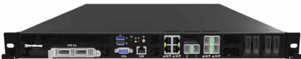
Аппаратная платформа «Рубеж С1» (передняя панель)
